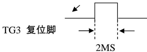
触发一次一个声音，mcu 高电平发出几个脉冲识别第几个声音，但在每次发出脉冲之前，必须个给 otp 复位
